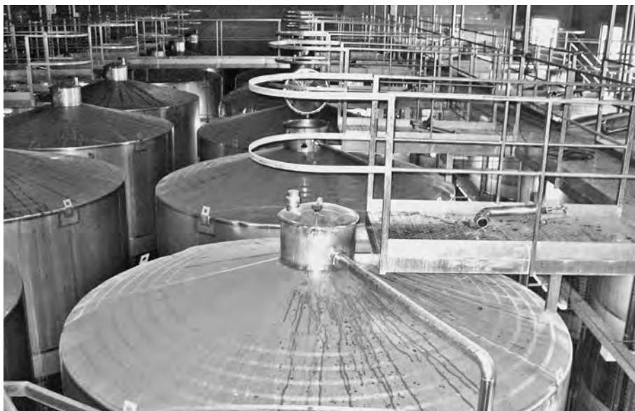
Vista superior dels dipòsits d'acer inoxidable de la nova nau per als vins negres
